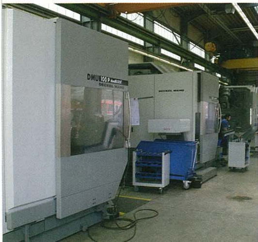
Drei DMU 100 und das Wotan Bohrwerk für die Großteilfertigung
