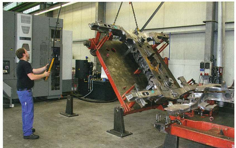
Rüst- und Ablageplätze: Besonders bei Großteilen ist das Handling entscheidend: Die Palette für die Wotan wird für das Umrüsten umgelegt.
