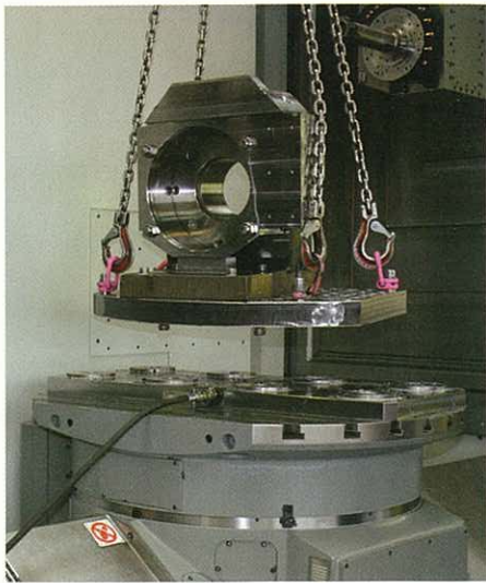
DMU 100: Optische Lösekontrolle – „Hydraulik sei Dank!“ Die Speedy's heben die Palette beim Lösen an. So ist ein sicheres Handling garantiert.
