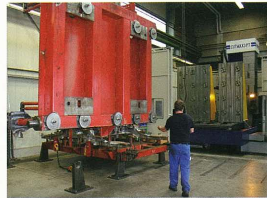
Maschinentisch der Wotan mit aufgespanntem Winkel 1 und Winkel 2. Im Vordergrund: Rüst- und Ablageplätze.
