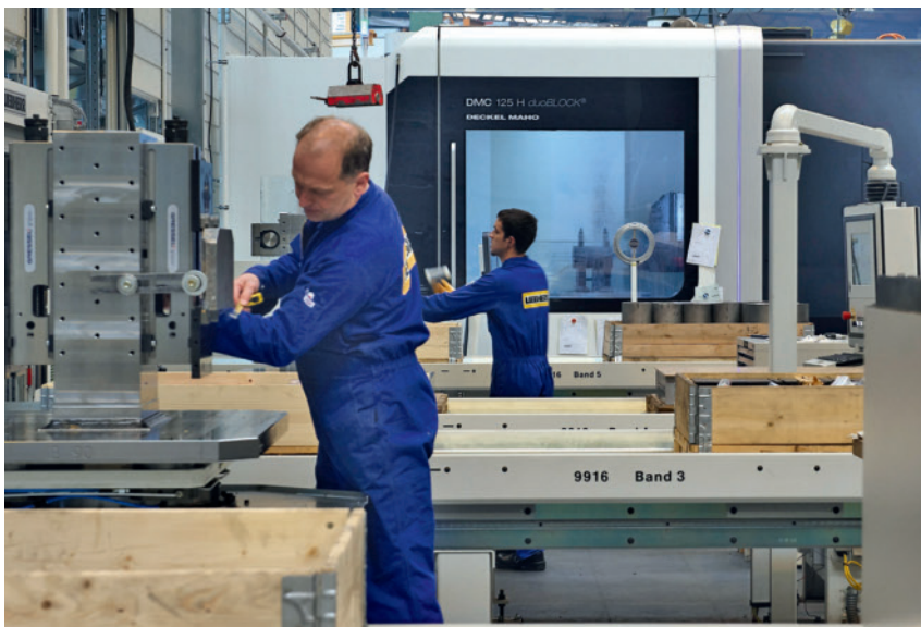
4 Optimales Umrüsten: vier Rüstplätze mit Zuführbändern, davon je ein Rüstplatz mit Fahr- oder kombinierter Fahr-, Kipp-, Drehachse sowie ein Europalettenband zur Rohteilzuführung
